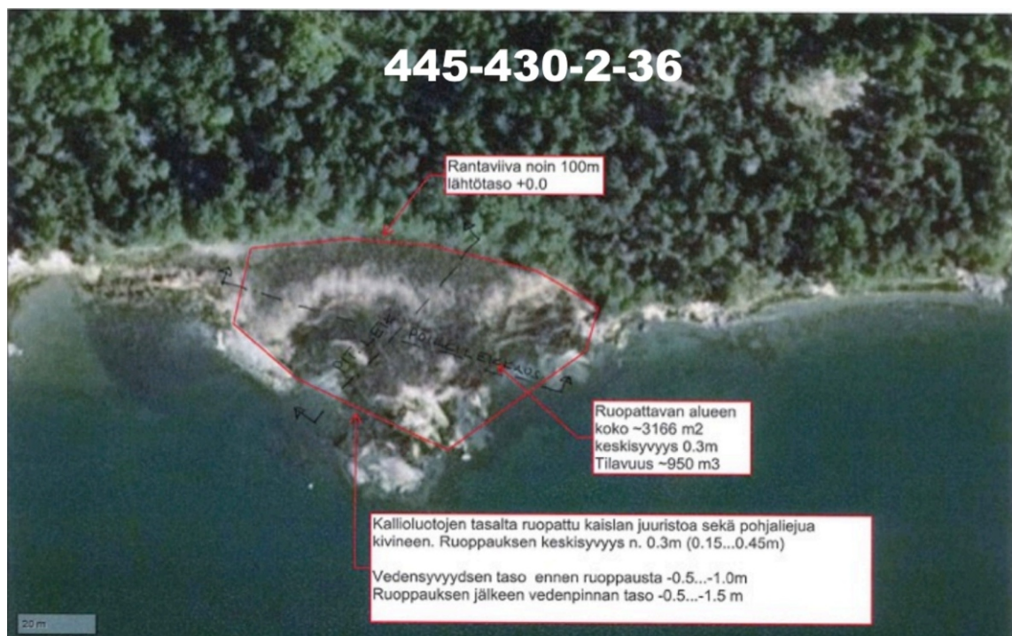
Toteutettu ruoppaus - förverkligad muddring
