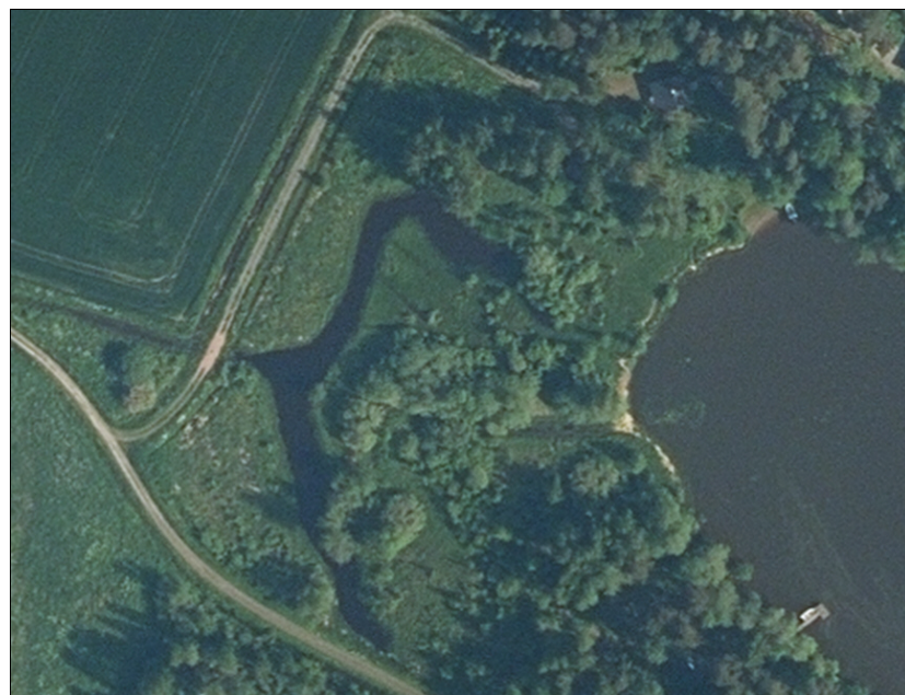
Spridningsdiken. Huvuddiket går in i en kanallik bassäng, där vattnet filtreras igenom en naturlig våtmark ner i vattendraget. (flygbild: MML 10/2019)
