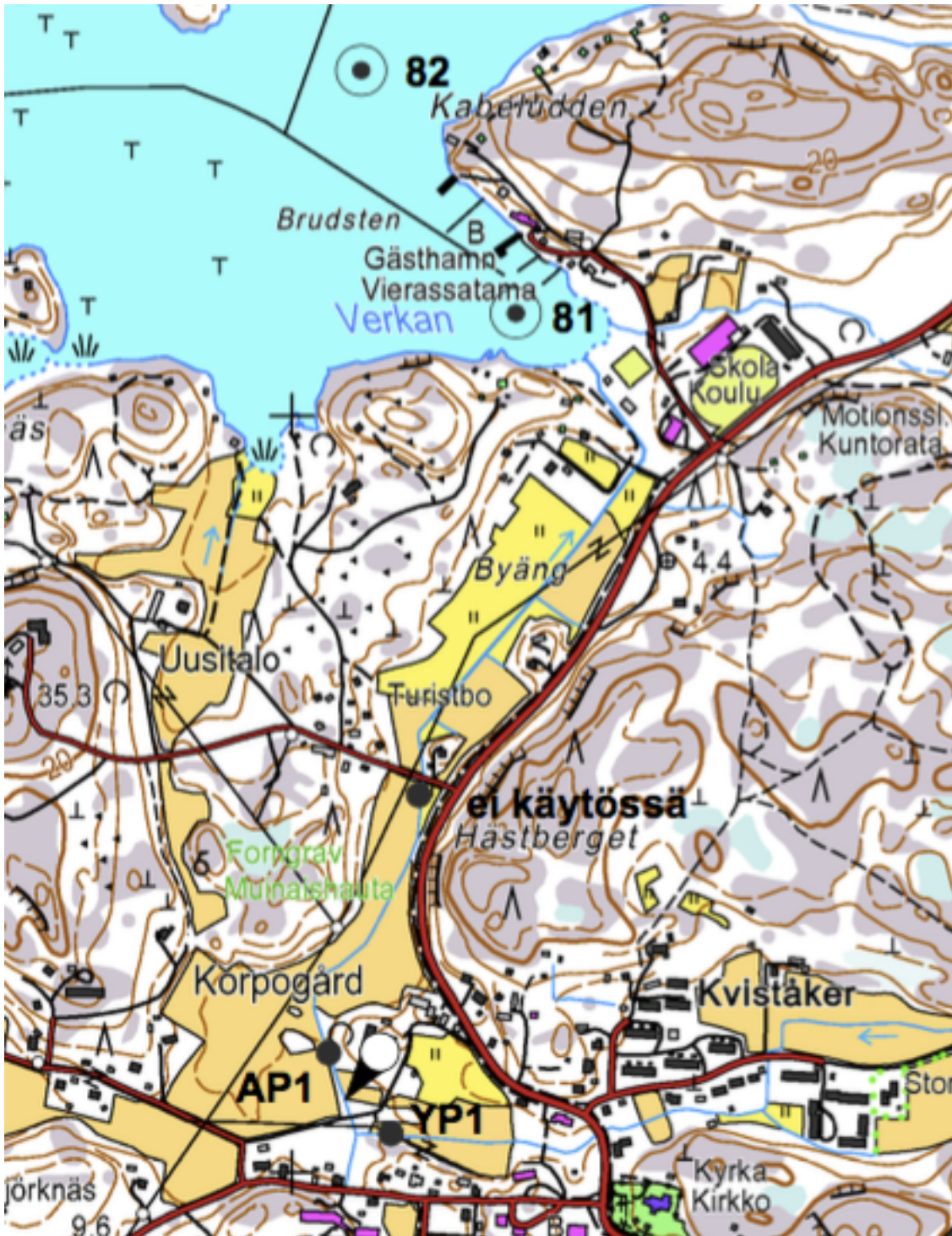
Kuva 7. Korppoon jätevedenpuhdistamon vesistötarkkailun näytipisteet: YP1= Korpogårdinoja (puhdistamon yläpuolella), AP1= Korpogårdinoja (puhdistamon alapuolella), 81= Verkaninlahti, 82= Sandholm
